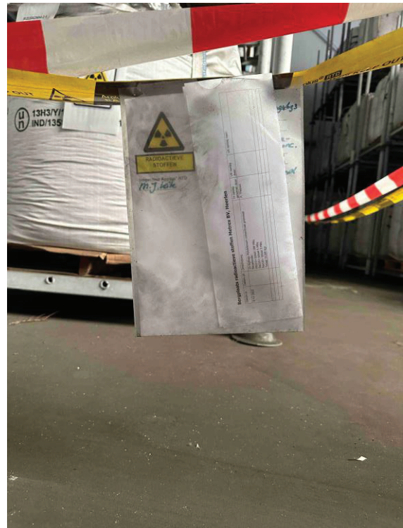
Register aangebracht direct aan de afzetting.
