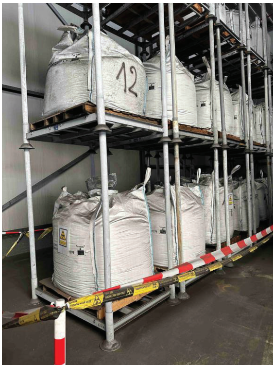
Foto 3: De in stalen frames geplaatste BigBags, verder afgezet met waarschuwingslint.
